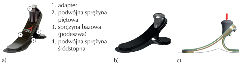
Rys. 1. Stopa protezowa: a) budowa; b) model geometryczny; c) model obciążeniowy
